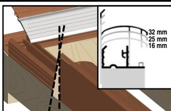
6. Clipsez le CLM dans le MP. Glissez les profils CLL sous le joint mural et clipsez-les sur les porteurs latéraux. Positionnez le CLL selon épaisseur plaque.
