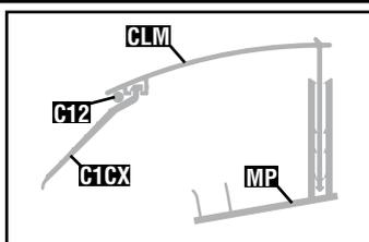
7. Installez le joint C12 rond entre le clips mural CLM et le joint C1CX pour augmenter la pression sur les plaques.
