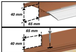
2. Enlevez 65 mm (gauche & droite) de la partie verticale des profilés muraux MP et CLM. Vissez le MP sur le chevron avec vis à tête noyée. Glissez le joint C1CX dans le CLM.
