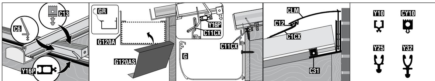
6. Fixez le joint d'étanchéité (C6). En cas de double vitrage, le joint C6 est serré par le Y16P contre le fraisage. Le joint de support C13 est fixé dans la rainure.
