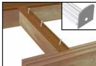
3. Posez les profilés TPH et TPHL jusque contre le profilé MP et vissez-les tous les 50 cm sur les porteurs en bois. Vissez l'arrêt S38.3 au côté perforé des porteurs de vitrage TPG & TPGL.
