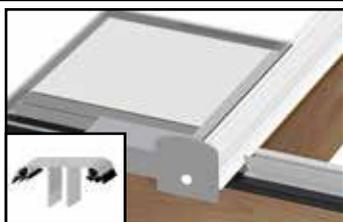
6. Installez le vitrage et collez le L432 sur le côté frontal du vitrage. Fixez les joints C8 dans les clips à serrage CLSB. Le profilé CY10/Y10/Y25 peut être utilisé en fonction de l'épaisseur de vitrage.
