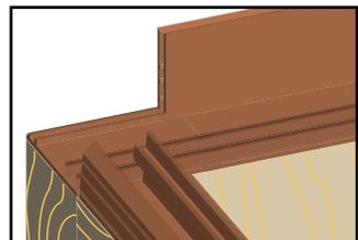
4. Fixez les profilés T16P jusqu'au profilé MP. Vissez avec vis à tête noyée dans les lumières pratiquées dans le T16P.
