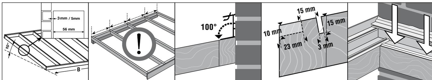
1. Implantez une structure portante en bois sous un angle de 10° (174mm/m). Si la construction se fait de manière latérale contre un mur, il faut prévoir un jeu de 3 mm. Pour des applications avec du vitrage, il faut prévoir un jeu de 5 mm.
